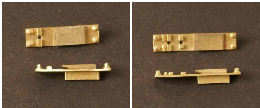
Rpg 21 (links) und Rpg 22 (rechts) mit aufgelöteter Gleitbahn
